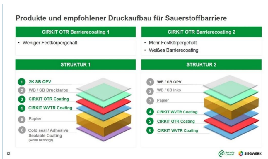
Struktureller Aufbau für Sauerstoffbarriere auf Papier. (Quelle Siegwirk Druckfarben AG & Co. KGaA)
