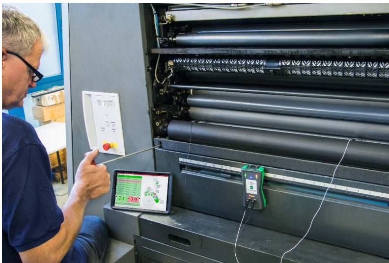
Bild 1: Ein Beispiel aus dem umfangreichen PITSID-Portfolio: Das NIP CON SMART zur schnellen und exakten Einstellung des Kontaktstreifens in Offsetmaschinen
