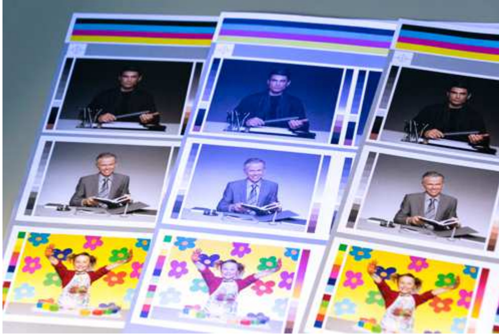
Bild 3: Einfluss optischer Aufheller auf den Farbeindruck: Beleuchtung unterschiedlicher Materialien mit UV-Licht
