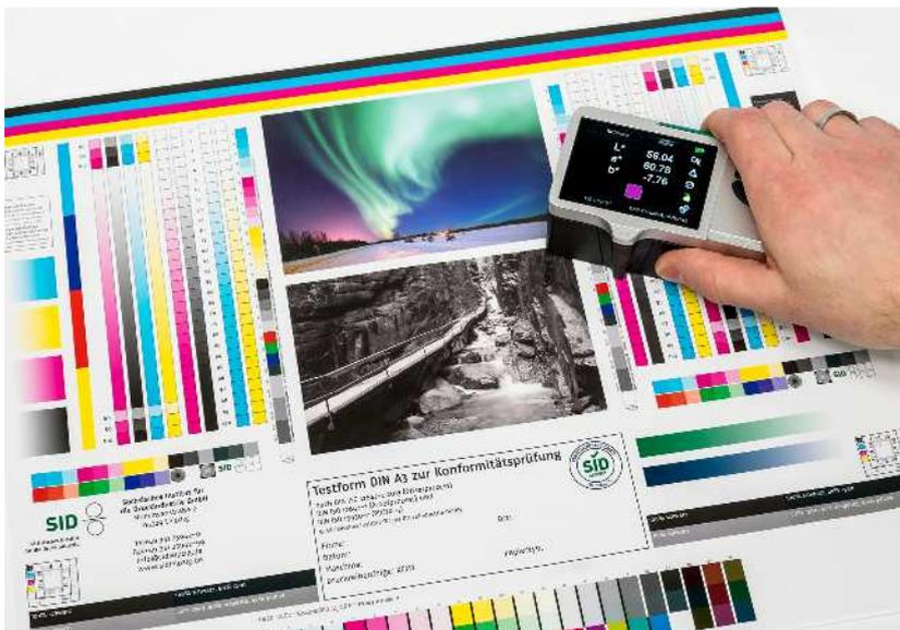
*Bild 2: Messung auf einem Testbogen im Rahmen einer PSO-Zertifizierung*
