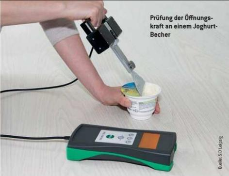
Prüfung der Öffnungskraft an einem Joghurt-Becher
