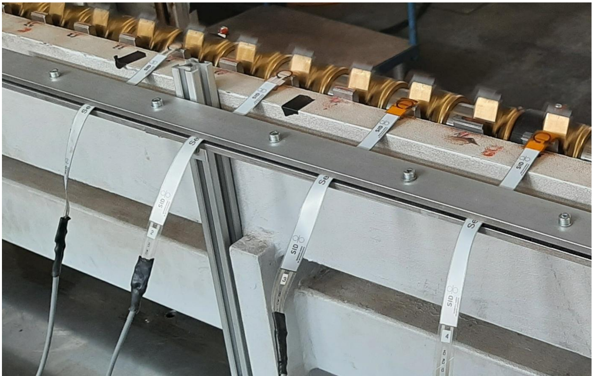
Abbildung 2: Test der Messsensoren in der Montage beim Druckmaschinenhersteller
