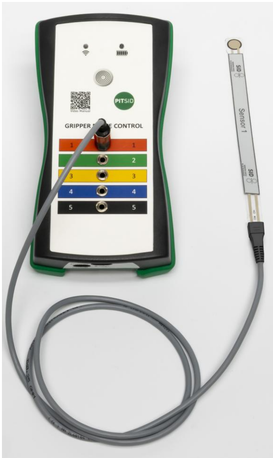
Abbildung 1: Prototyp Handmessgerät zur Greiferkraftmessung
