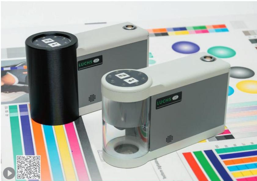
Abb. 1: Passermesssystem LUCHS V (Quelle: PITSID GmbH)
