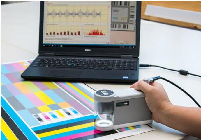
Abb. 1: Passermesssystem LUCHS IV (Quelle: PITSID GmbH)
