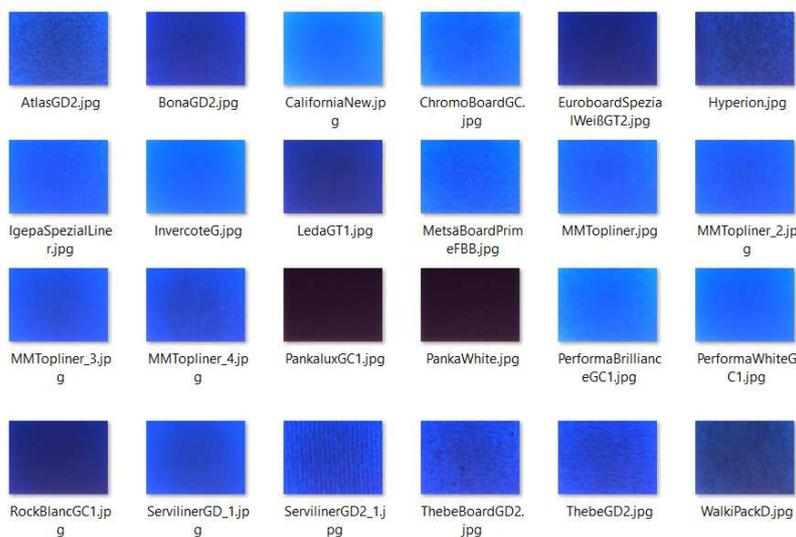
*Darstellung des Blauanteils der Remission bei Beleuchtung mit UV-Licht für verschiedene GD2-Kartons. Die unterschiedliche Helligkeit ist ein Maß für den Gehalt an optischen Aufhellern.*
