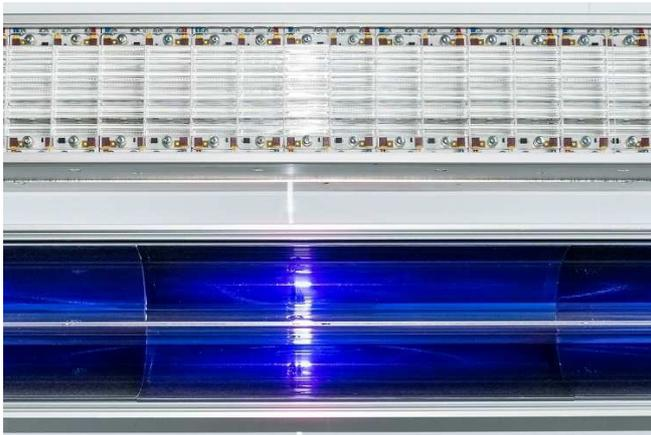
*LED-UV-Strahler (oben) und UV-Mitteldruckstrahler im Vergleich, gut zu erkennen ist der unterschiedliche Aufbau der Strahler*
