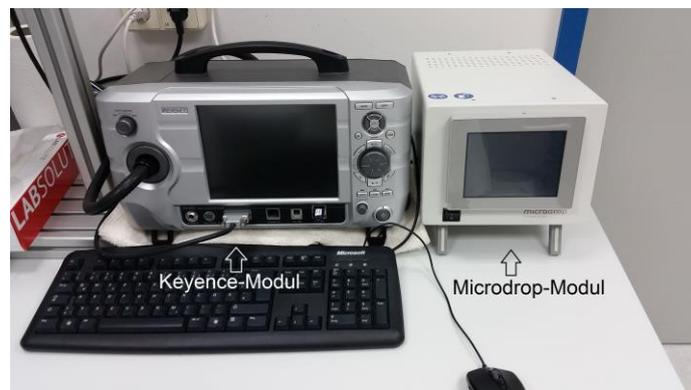
Abbildung 20: Unterstützende Hardware zur Steuerung der Highspeed-Kamera und des Dispensers.
