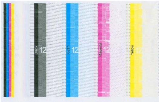
Abbildung 9: Bei zu geringer Spannung (in Abbildung 60% der empfohlenen Spannung), reicht die Energie nicht zur Tropfenbildung und Tropfenlösung vom Druckkopf aus. Die Linien sind unvollständig und erscheinen ausgefranst.
