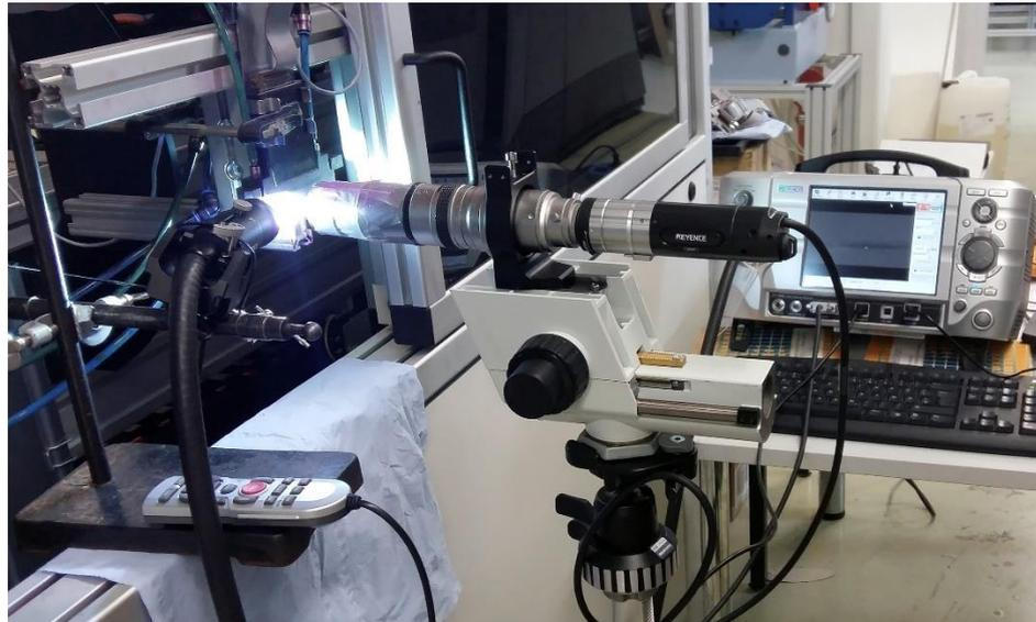
Abbildung 23: Kameraaufbau zur Beurteilung des Tropfenauffreffens auf den Bedruckstoff
