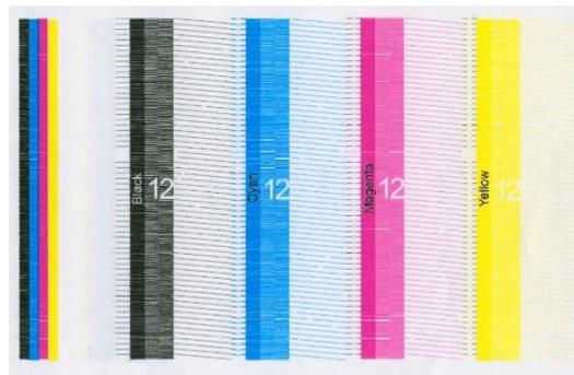
Abbildung 8: Bei 96% der empfohlenen Spannung wurde eine zu hohe Farbmenge ausgegeben und somit feine einzelne Linien zu breiten Linien zusammengedrückt
