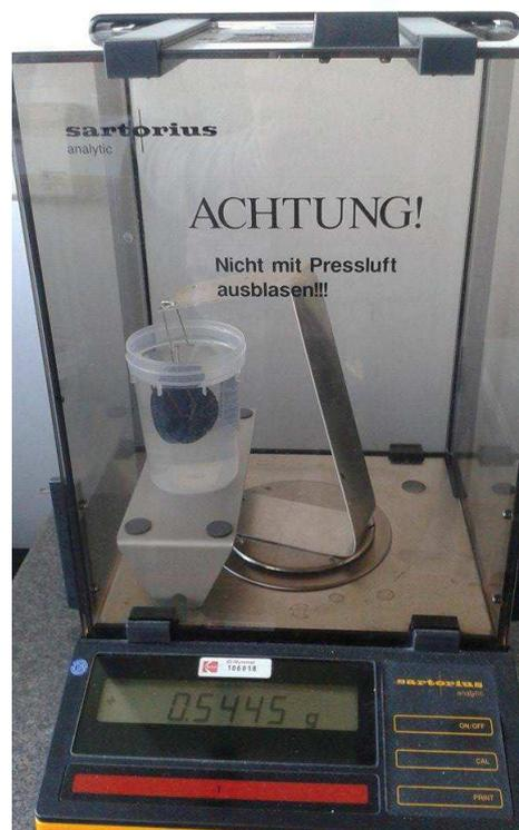
Abbildung 6: Prüfung der scheinbaren Masse der Probenkörper in Wasser
