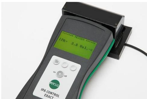
Messgerät IPA Exact mit temperierbarem Probenbehälter
