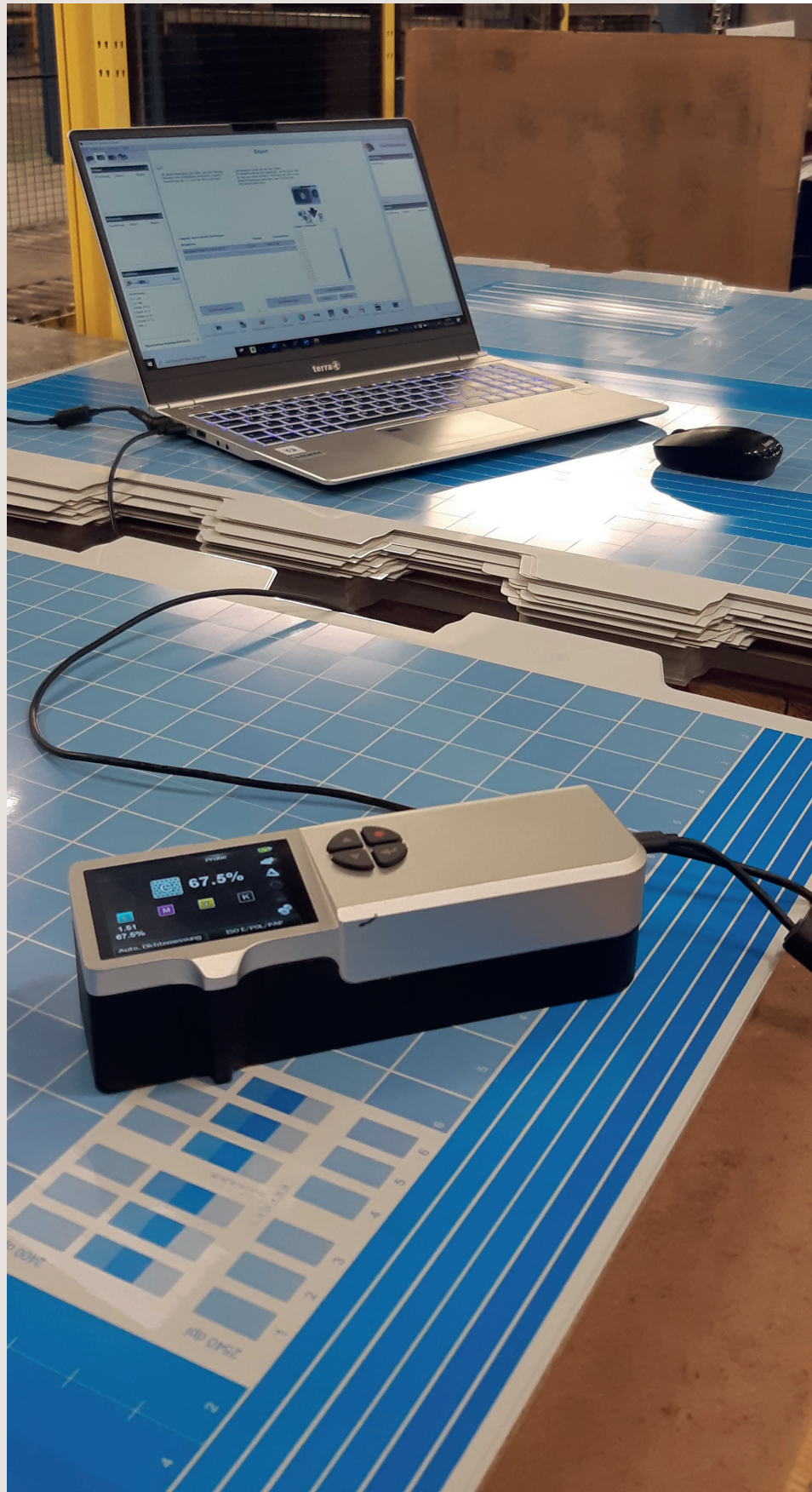
Speziell angepasste Testformen dienen dazu, eine gebrauchte Druckmaschine gründlich zu prüfen.
