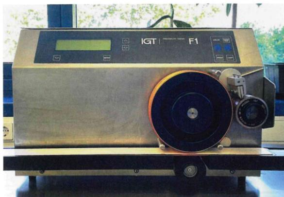
Flexo-Probendruckgerät IGT F1
