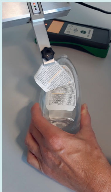
Prüfung der Öffnungskraft
