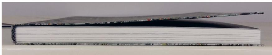
Abbildung 2: Kopf-Fuß-Bereich bei 35 Prozent relativer Luftfeuchte.
