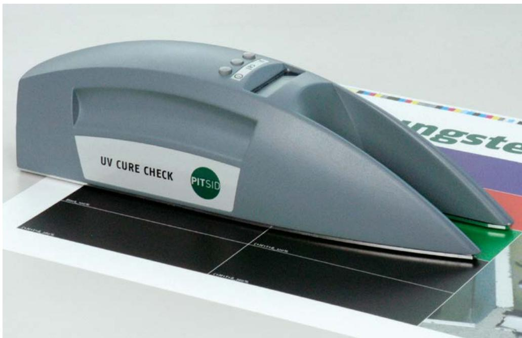
UV-Härtungs-Prüfgerät „UV Cure Check“.
