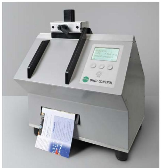
Klebebindungs-Prüfgerät „Bind Control“.
