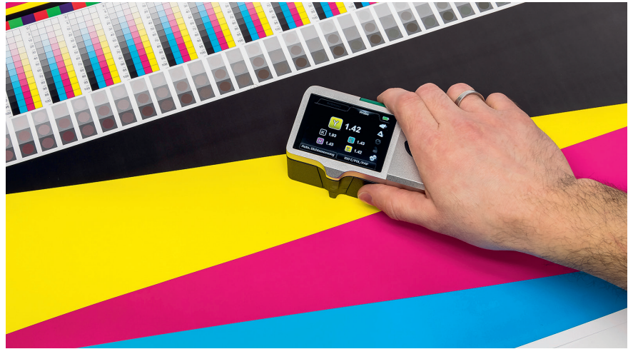
Ermittlung des idealen Farbortes und der idealen Nassdichten.
