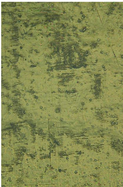
Beschädigungen der Oberfläche des aufgetragenen Antirutschlacks.
