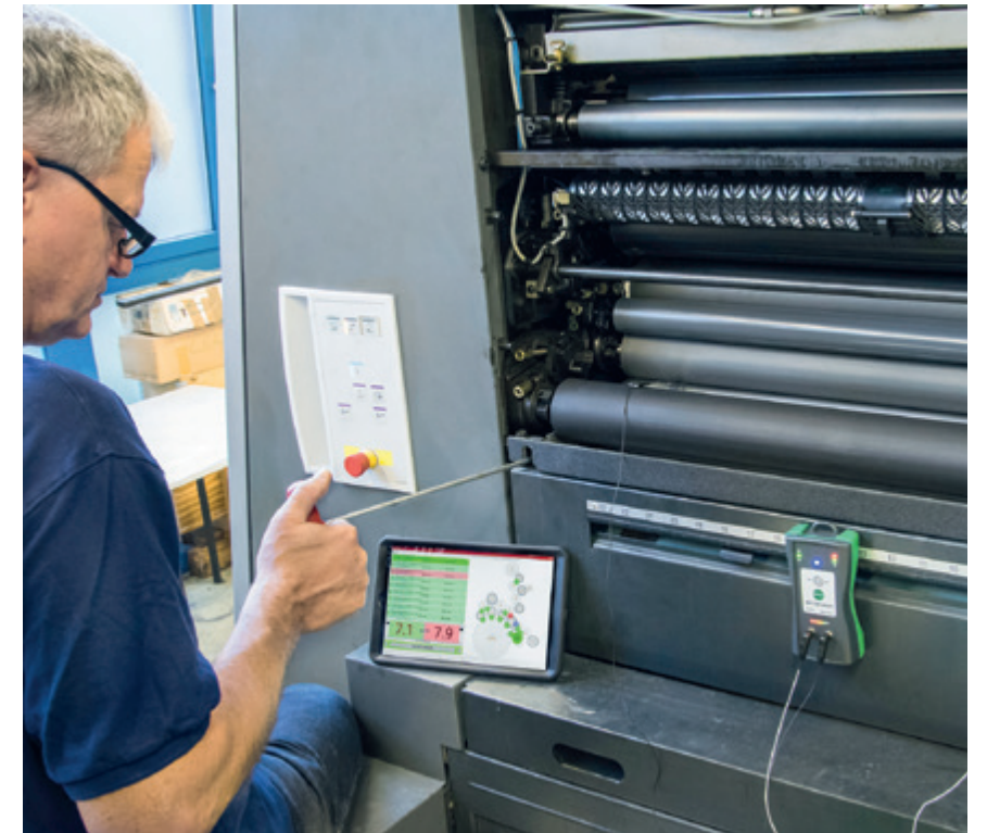
Digitale Technik unterstützt die Einstellung des Walzenstuhls einer Offsetdruckmaschine.
