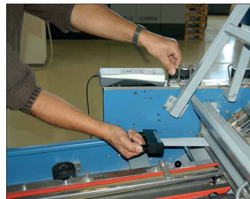
Messvorgang mit dem Zugkraftmessgerät Trac Control
