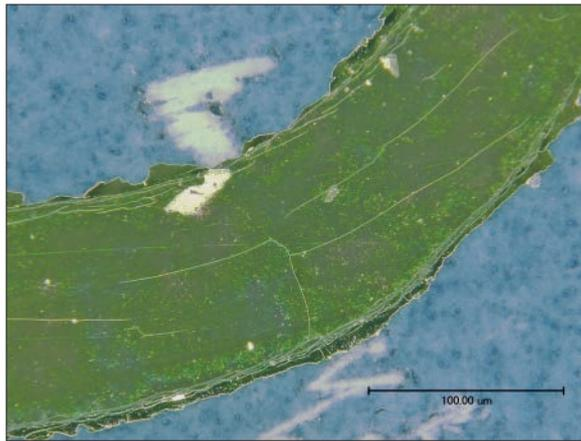
Schrift, jedoch immer unterhalb der Folienkaschierung. Die Beschädigungen waren also bereits vor dem Kaltfolienkaschieren entstanden. Wegen der unterschiedlichen Orientierung und Länge der Kratzer konnte zudem eine Beschädigung durch eine wiederkehrende Bewegung, etwa an einem Anleger, ausgeschlossen werden. Zudem war auch die Form der Kratzer für eine Beschädigung in der Fertigungsstrecke untypisch.
