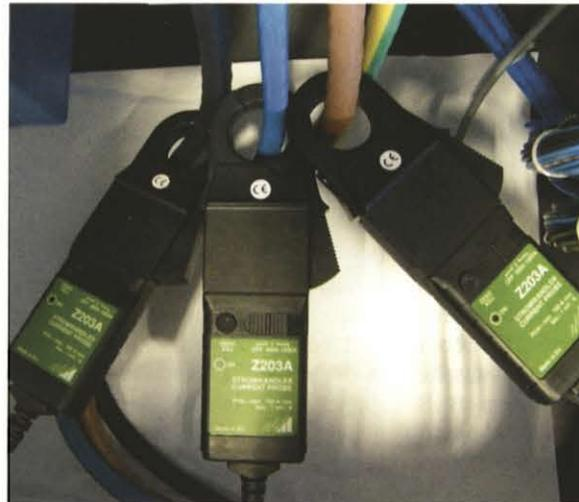
Stromabgriff an einem Infrarot-Heißlufttrockner
