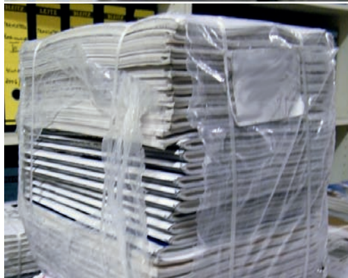
Typische Versandschäden an folierten und umreiften Paketen von Broschüren.
