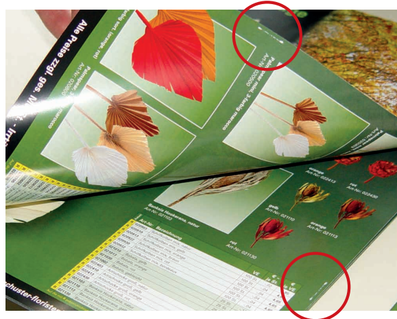
Die ausgelieferten Broschüren wiesen linienförmige Fehlstellen auf.
